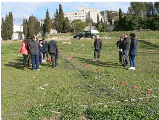
Fig. 4. Etapas de una actuación geofísica: (a) Adquisición de datos de tomografía eléctrica 2.5D en el Alfár Romano. Se inyecta corriente al subsuelo y se miden las diferencias de potencial.
