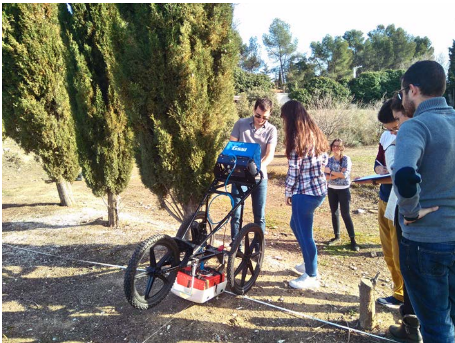
Fig. 3. (a) Práctica de georradar en el Alfár Romano. Se inyectan ondas electromagnéticas en el subsuelo y se reciben las reflexiones producidas en los distintos materiales. El modelo resultante es una imagen de los cuerpos reflectantes soterrados.
