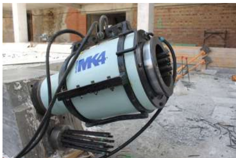
Máquina de tensado de la armadura de las grandes vigas del forjado del patio nuevo – techo del aula magna. Año 2012
