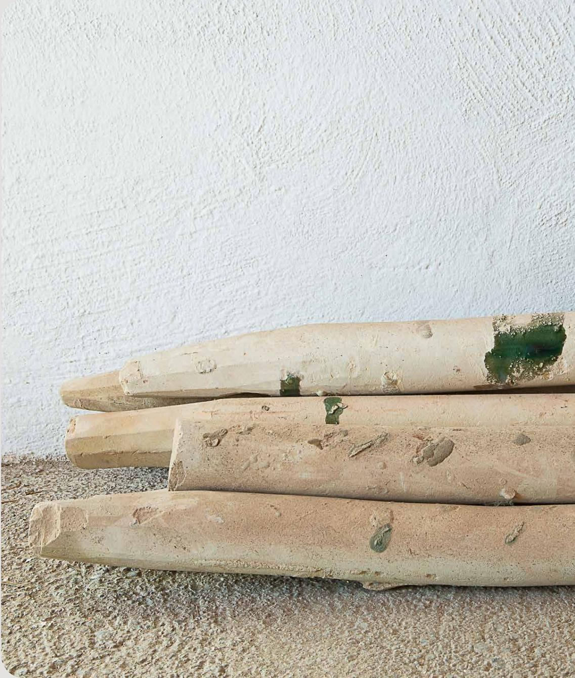
*Gumares. Piezas para montar la estructura interna del horno árabe*
