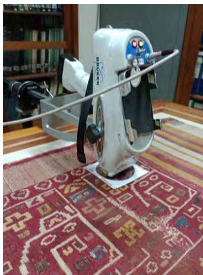
Análisis de paño lana mediante espectroscopía. Colección textil | foto Patricia Gonzales
